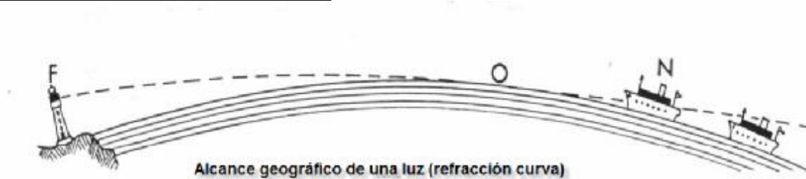
Según la definición que contempla el **Diccionario de la IALA 2-1-25**, el alcance geográfico de una señal marítima es *“La mayor distancia a la que un objeto o fuente de luz puede verse bajo condiciones de perfecta visibilidad, limitado solamente por la curvatura de la tierra, la refracción de la atmósfera, la elevación del observador y el objeto o luz”*.
