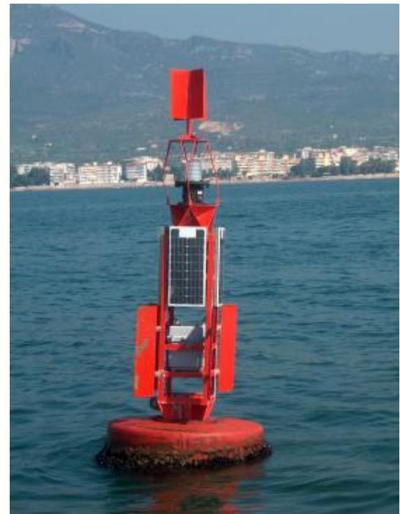
**Ejemplos de marcas diurnas para aguas navegables (arriba), laterales de babor y estribor (abajo) y marcas de tope. Los tamaños vienen condicionados por el diámetro de las boyas..**
