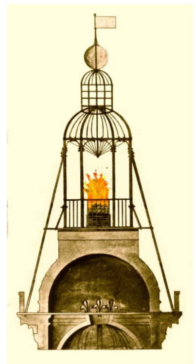
Linterna para carbón del Faro francés de Cordouan
