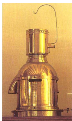
Lámpara Chance para capillos de 85 mm por incandescencia de vapor de petróleo a presión
