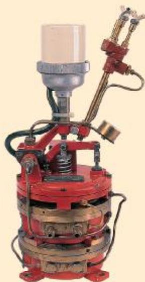
**Nº: 04. LÁMPARA ELÉCTRICA CON RESERVA DE GAS ACETILENO / NÚM.: 04. LÁMPADA ELÉCTRICA AMB RESERVA DE GAS ACETILE / NO. 04. ELECTRIC LAMP WITH ACETYLENE GAS RESERVE**
