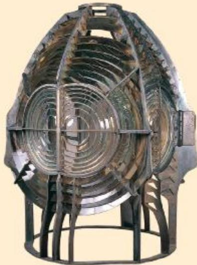
**Nº: 04. ÓPTICA DIÓPTRICA CATADIÓPTRICA PARA FARO GIRATORIO / NÚM.: 04. ÓPTICA DIÓPTRICA CATADIÓPTRICA PER A FAR GIRATORI / NO. 04. DIÓPTIC CATADIOPTRIC OPTIC FOR A REVOLVING LIGHT.**
