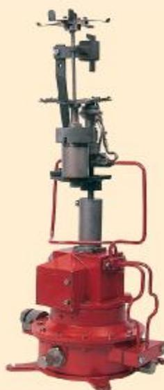
**Nº: 06. CONJUNTO DE QUEMADOR POR CAPILLOS INCANDESCENTES CON CAMBIADOR AUTOMÁTICO PARA GAS ACETILENO / NUM.: 06. CONJUNT DE CREMADOR PER COBERTORS DE BITACOLA INCANDESCENTS AMB CANVIADOR AUTOMÀTIC PER A GAS ACETILÈ / NO. 06. INCANDESCENT ACETYLENE GAS MANTLE BURNER WITH AUTOMATIC CHANGER**
