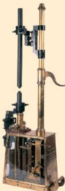
**Nº: 02. LÁMPARA DE ARCO VOLTAICO PARA FARO ELÉCTRICO (FARO DE VILLANO A CORUÑA) / NUM.: 02. LAMPADA D'ARC VOLTAIC PER A UN FAR ELÉCTRIC (FAR DE VILLANO -LA CORUNYA) / NO. 02. VOLTAIC ARC LAMP FOR AN ELECTRIC LIGHTHOUSE (VILLANO LIGHTHOUSE - LA CORUNA)**
