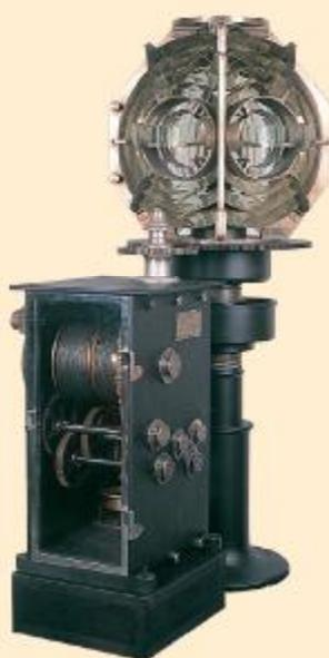
**Nº: 09. APARATO GIRATORIO CON ÓPTICA DIÓPTICA CATADIÓPTICA CON PANELES DE HAZ AEREO / NUM.: 09. APARELL GIRATORI AMB ÒPTICA DIÒPTICA CATADIÒPTICA AMB PANELLS DE FEIX AERI / NO. 09. REVOLVING MECHANISM WITH A DIOPTRIC CATADIOPTRIC OPTIC AND AERIAL BEAM PANELS**
