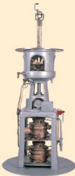
**Nº: 04. BASAMENTO PARA ÓPTICA GIRATORIA Y CAPILLOS INCANDESCENTES DE GAS ACETILENO / NUM.: 04. BASAMENT PER A ÒPTICA GIRATÒRIA I COBERTORS DE BITACOLA INCANDESCENTS DE GAS ACETILÈ / NO. 04. PLINTH FOR A REVOLVING OPTIC AND INCANDESCENT ACETYLENE GAS MANTLES**
