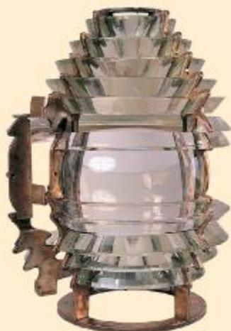
**Nº: 03. ÓPTICA DIÓPTICA CATADIÓPTICA DE HORIZONTE PARA FARO DE 5º ORDEN (PLAN DE 1847) / NUM.: 03. ÒPTICA DIÓPTICA CATADIÓPTICA D'HORIZO PER AL FAR DE 5E ORDRE (PLA DE 1847) / NO. 03. DIOPTRIC CATADIOPTRIC HORIZON OPTIC FOR A 5TH ORDER LIGHTHOUSE (1847 PLAN)**
