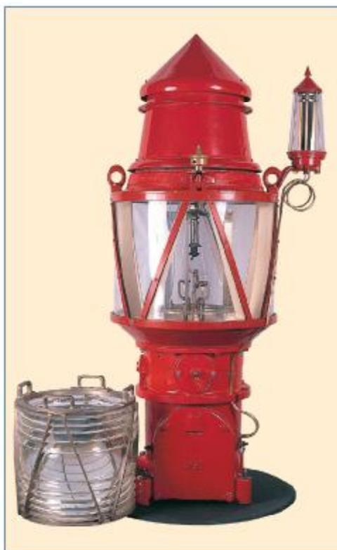
**Nº: 10. LINTERNA CON ÓPTICA E INSTALACION DE GAS ACETILENO SISTEMA DALEN, EQUIPADA CON VALVULA SOLAR / NUM.: 10. LLANTERNA AMB ÒPTICA I INSTAL·LACIÓ DE GAS ACETILE SISTEMA DALEN, EQUIPADA AMB VÁLVULA SOLAR / NO. 10. LANTERN WITH OPTIC AND INSTALLATION FOR A DALEN. ACETYLENE GAS SYSTEM, EQUIPPED WITH A SOLAR VALVE**
