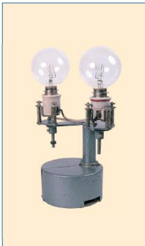
**Nº: 03. CAMBIADOR AUTOMÁTICO PARA LÁMPARAS ELÉCTRICAS / NÚM.: 03. CANVIADOR AUTOMÀTIC PER A LAMPARES ELÈCTRIQUES / NO. 03. AUTOMATIC CHANGER FOR ELECTRIC LAMPS**
