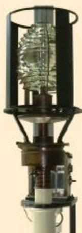
**Nº 08. CONJUNTO DE APARATO ÓPTICO GIRATORIO CON PANTALLAS DE OCULTACIÓN PARA FARO / NUM: 08. CONJUNT D'APARELL ÒPTIC GIRATORI AMB PANTALLES D'OCULTACIÓ PER A FARO / NO. 8. REVOLVING OPTICAL APPARATUS WITH OCCULTATION SCREENS FOR A LIGHTHOUSE**
