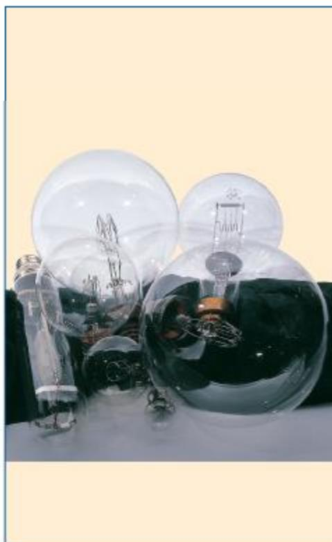
**Nº 08. DIVERSOS TIPOS DE LÁMPARAS ELÉCTRICAS PARA FAROS / NÚM. 08. DIVERSOS TIPUS DE LAMPARES ELÈCTRIQUES PER A FAROS / NO. 08. VARIOUS TYPES OF ELECTRIC LAMPS FOR LIGHTHOUSES**
