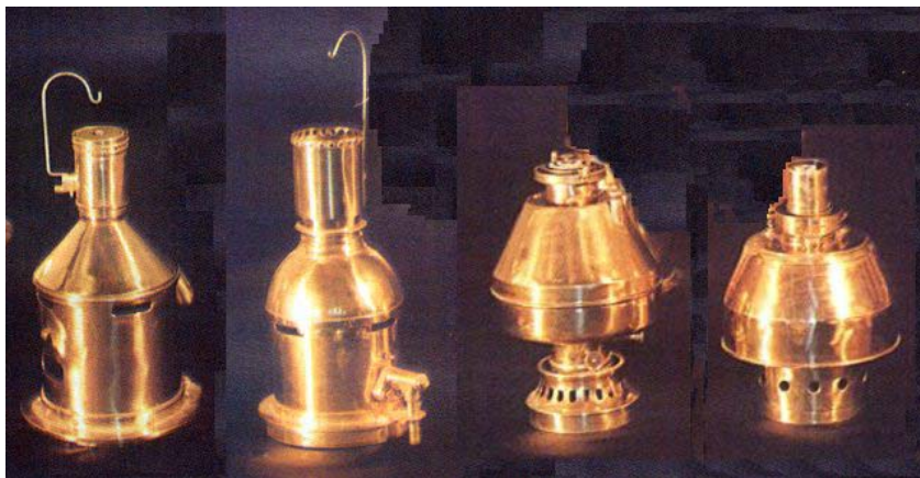
Lámparas Maris de aceite, parafina y petróleo y lámparas Chance de incandescencia por vapor de petróleo a presión recuperadas de los faros de las Islas Baleares y que se encuentran expuestas en el Museo de Portopí
