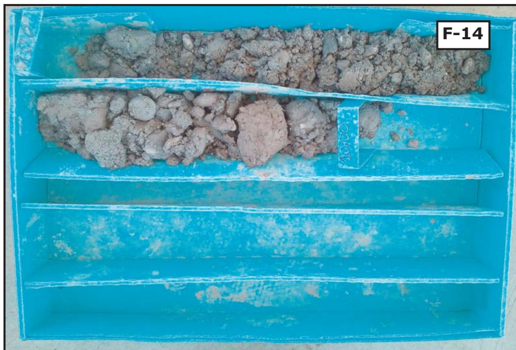
Fotografías 13 y 14: Detalle de los materiales recuperados en el sondeo S-3 entre las cotas de -6.0 a -9.0 metros y entre las cotas de -9.0 a -10.0 metros.
