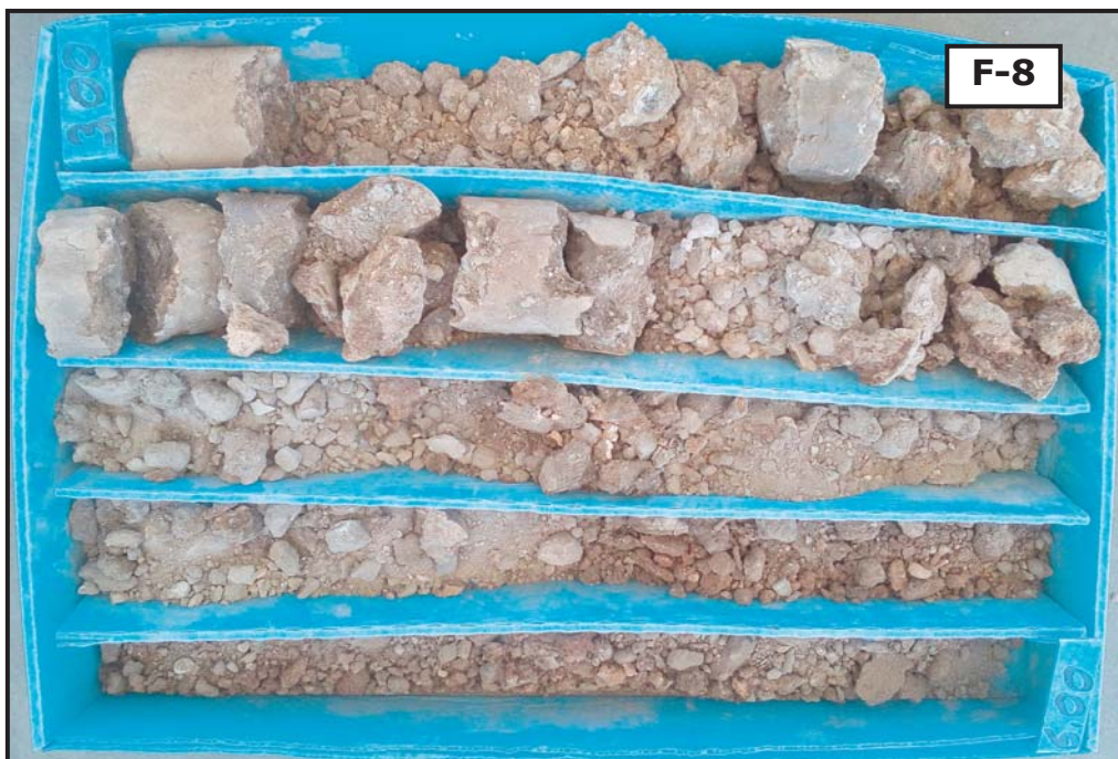
Fotografías 7 y 8: Detalle de los materiales recuperados en el sondeo S-2 entre las cotas de 0.00 y -3.00 metros y entre las cotas de -3.00 y -6.00 metros.
