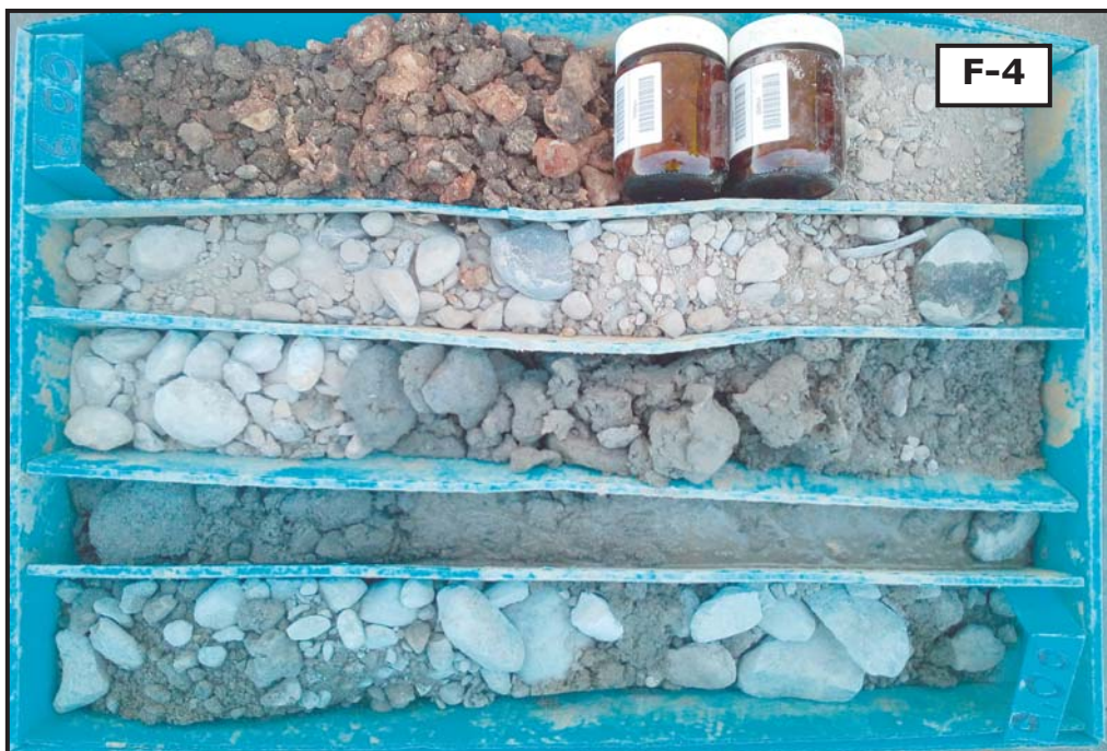
Fotografías 3 y 4: Detalle de los materiales recuperados en el sondeo S-1 entre las cotas de -3.0 a -6.0 metros y entre las cotas de -6.0 a -9.0 metros.
