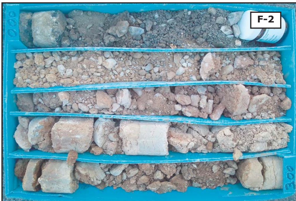
Fotografías 1 y 2: Vista del emplazamiento de la máquina para la realización del sondeo S-1 y detalle de los materiales recuperados en el sondeo S-1 entre las cotas de 0.0 a -3.0 metros.
