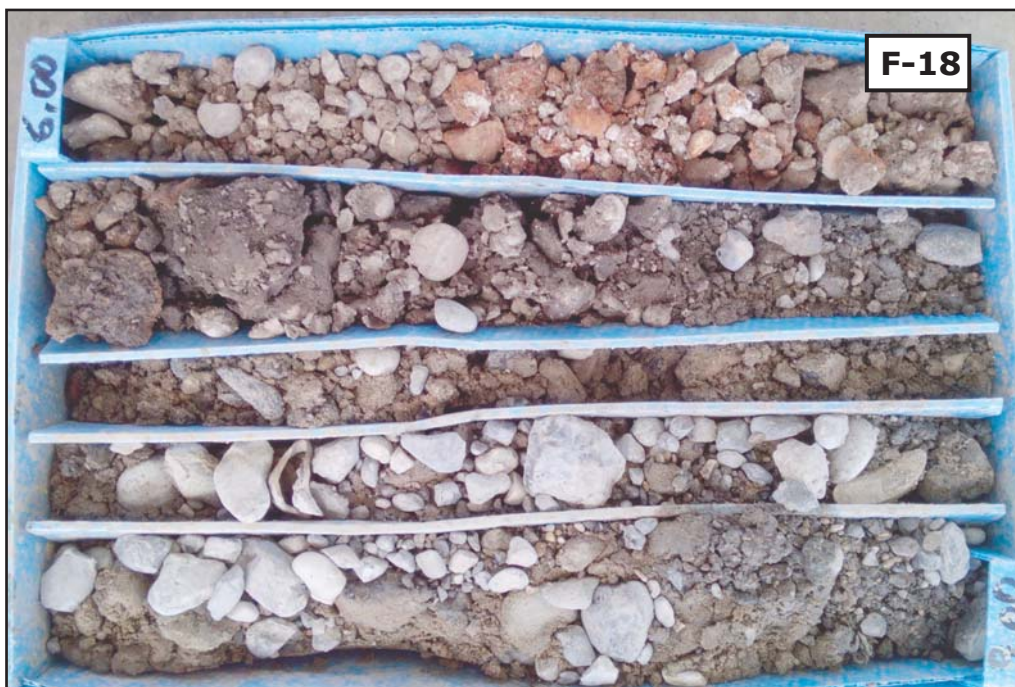
Fotografías 17 y 18 : Detalle de los materiales recuperados en el sondeo S-4 entre las cotas de -3.0 a -6.0 metros y entre las cotas de -6.0 a -9.0 metros.
