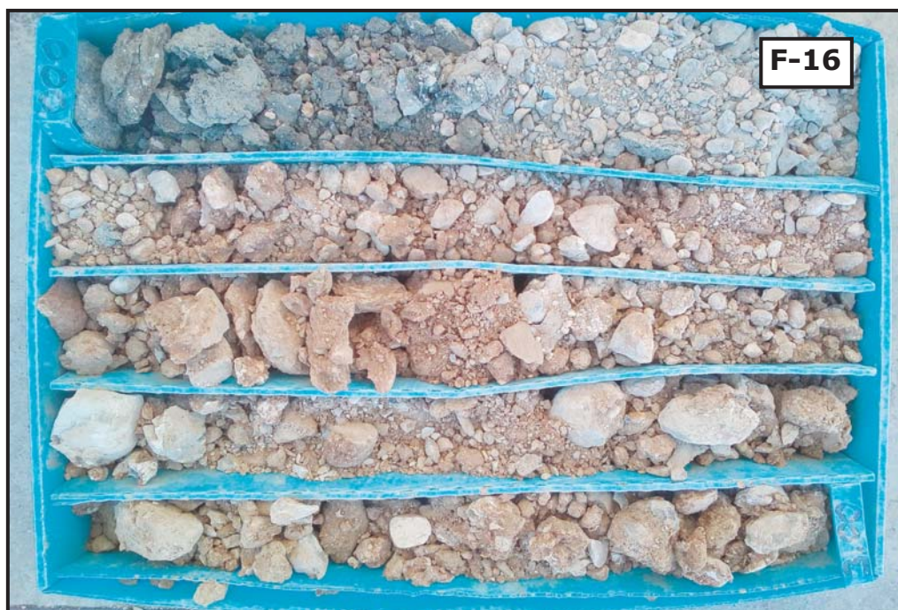
Fotografías 15 y 16: Vista del emplazamiento de la máquina para la realización del sondeo S-4 y detalle de los materiales recuperados en el sondeo S-4 entre las cotas de 0.0 a -3.0 metros.
