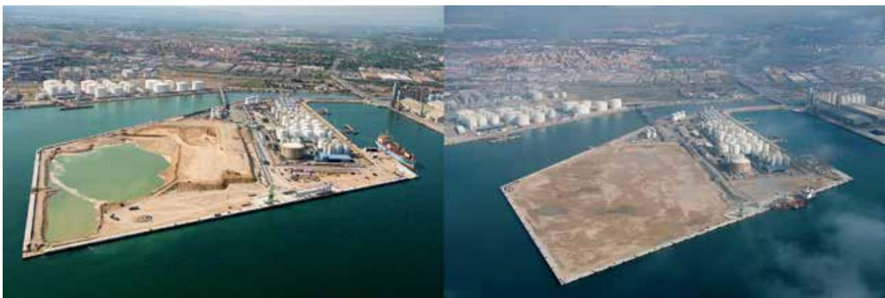
Dragado del canal de entrada al puerto para el aumento de 1 m de la explanada hasta la cota -2 m y la realización de las precargas de toda la nueva explanada de 18 ha.
