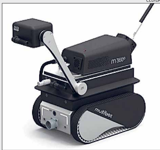
El robot MULTIBOT realitza la higienització de conductes.
