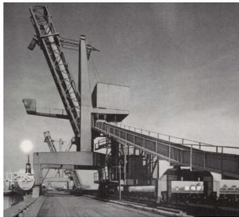
Las cintas transportadoras son móviles o fijas. Las móviles tienen un tren de rodaje para trasladarlas y un medio normalmente hidráulico para elevar uno de sus extremos. Hay cintas móviles pequeñas que se usan para manejar sacos y otros bultos, permitiendo el acceso de los sacos a la parte superior de las pilas o a los camiones o vagones. Las móviles, de mayor tamaño, se usan para cargar y manejar graneles. Las cintas fijas son utilizadas también para estos fines.
