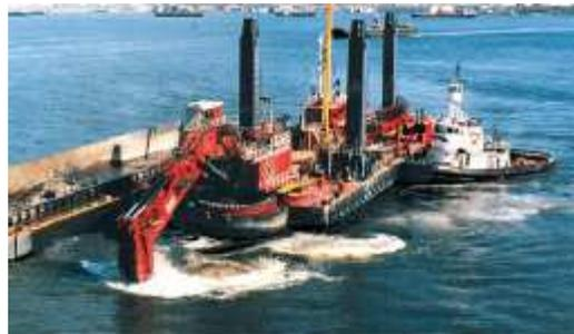
***Draga caramarro.*** Es una grúa con cuchara de almeja instalada sobre una lancha. La cuchara, accionada por cables, desciende abierta hasta el fondo, donde excava, se cierra y extrae el material. Puede alcanzar prácticamente cualquier profundidad y dragar áreas muy localizadas
