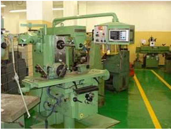
Fresadora universal con sus accesorios.
