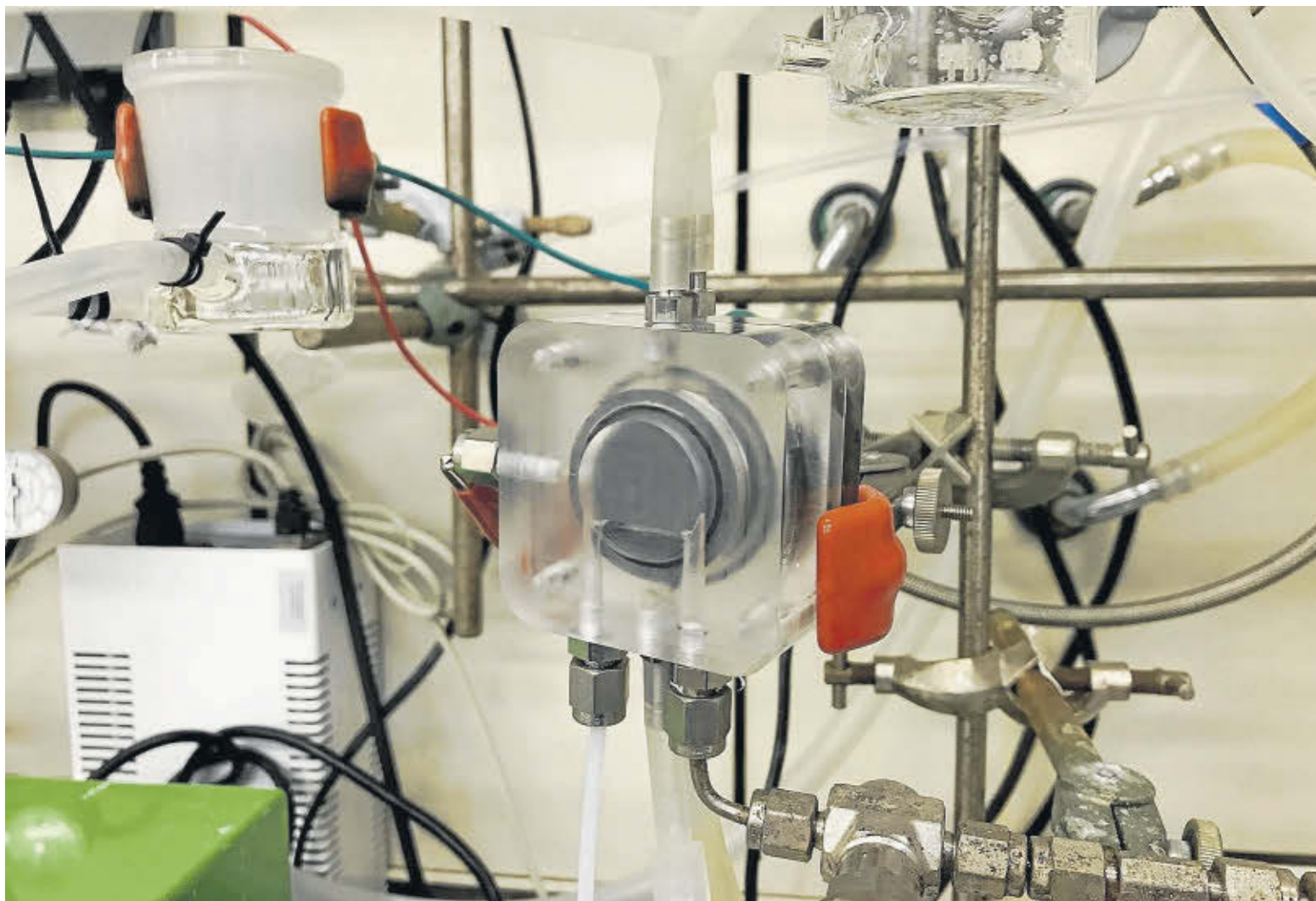
El ICIQ lidera el proyecto A-Leaf, con el que han creado un dispositivo que capta el CO2 y lo convierte en combustible. FOTO: ICIQ
