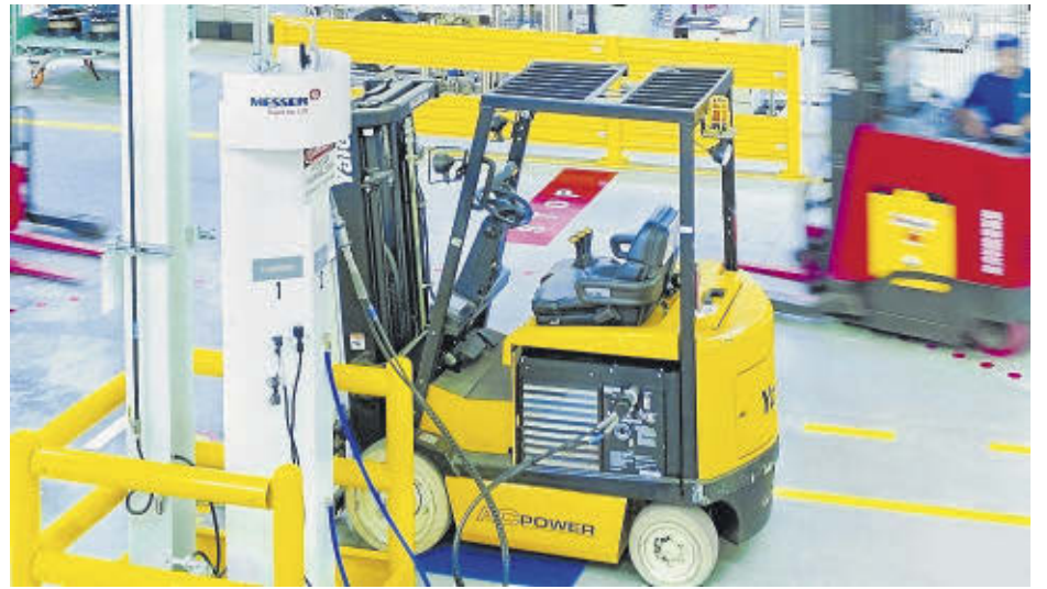
En Messer el hidrógeno verde ya se aplica en vehículos móviles. FOTO: CEDIDA
