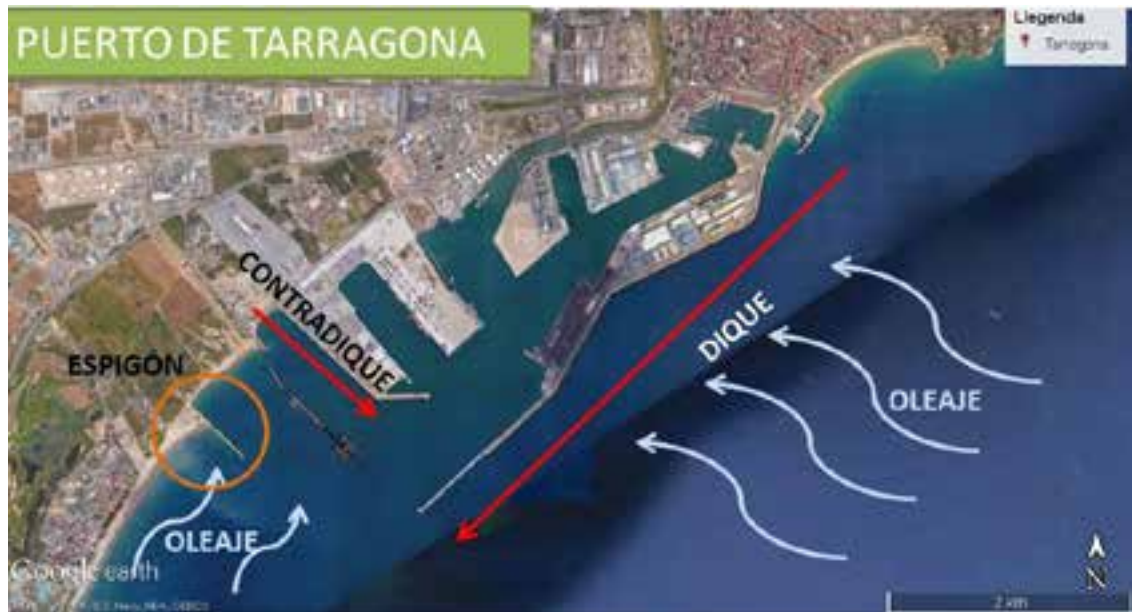
Fig. 45. Principales estructuras del puerto moderno de Tarragona.
