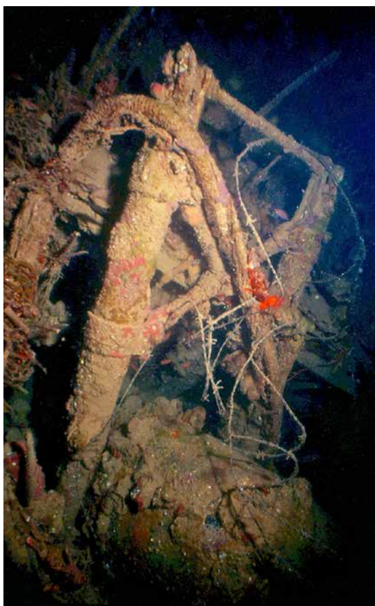
El tren d'aterratge de l'ala esquerra. Aquesta peça ha desaparegut, juntament amb els dos pneumàtics. Any 1992. Fotografia: Josep Maria Castellví.
