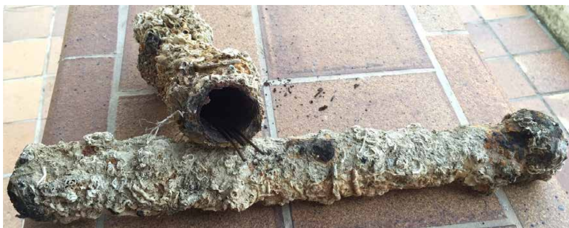
Beines sense projectil i sense gastar, extretes de les restes del Kilissi pels bussos que van desballestar-lo als anys 50-60. Són visibles algunes restes de les barretes del propel·lent altament inflamables. Fotografia: Josep Maria Castellví.
